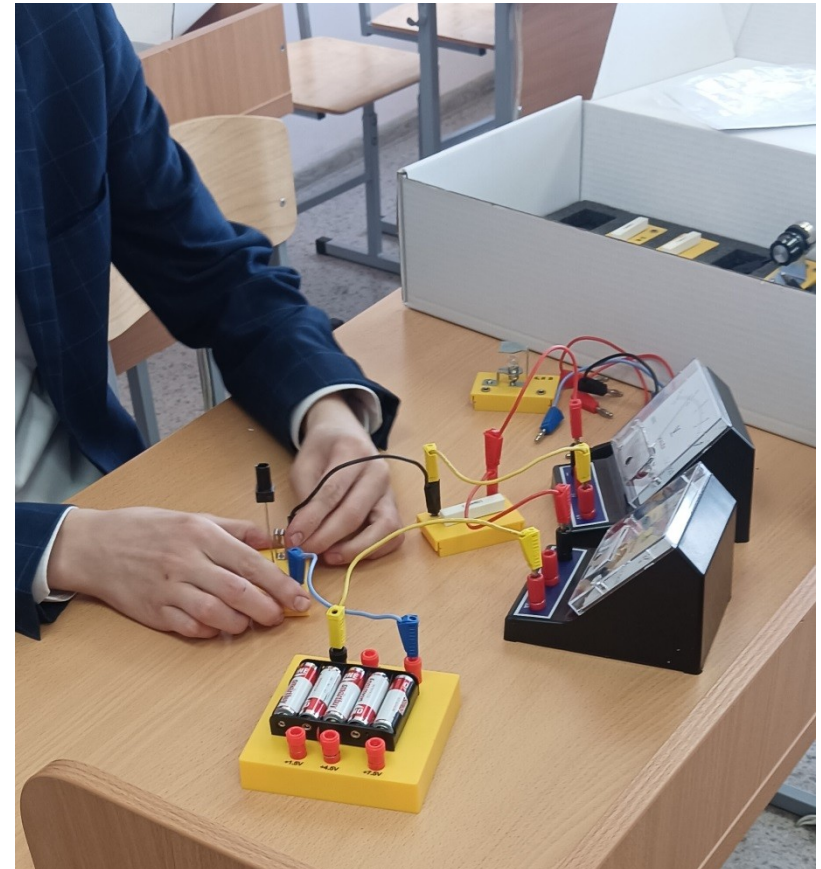
«Измерение электрического сопротивления резистора»
