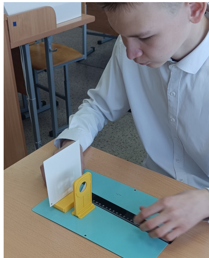
«Определение оптической силы и фокусного расстояния собирающей линзы»
